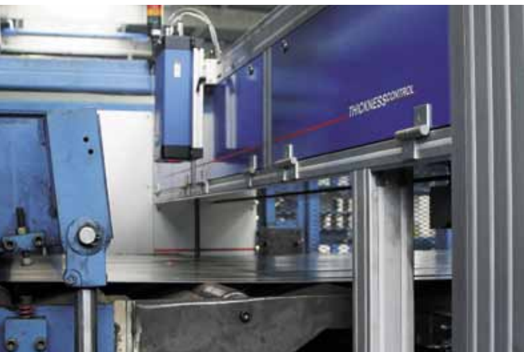
РИС. 6. Полное измерение с записью длины с использованием технологии ASCOSpeed
