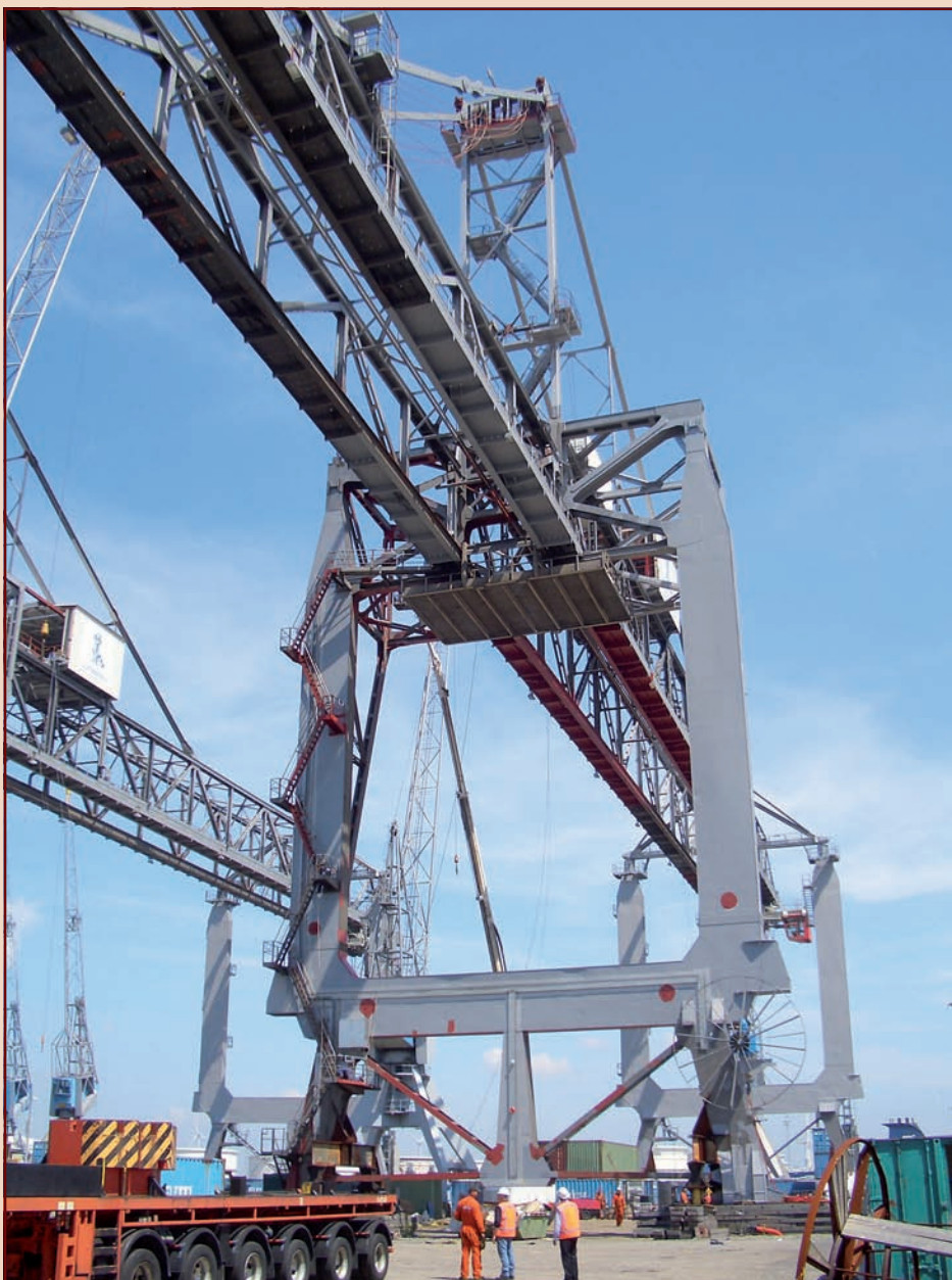
Ship-to-shore-kraan bij C. Steinweg in Rotterdam. De kranen zijn uitgerust met laserafstandsensoren tegen botsingen.
