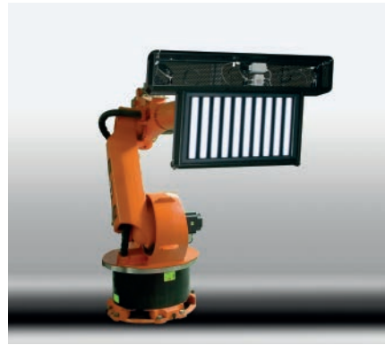
Das System Reflect Control an einen Roboter montiert prüft ganze Automobilkarosserien.
