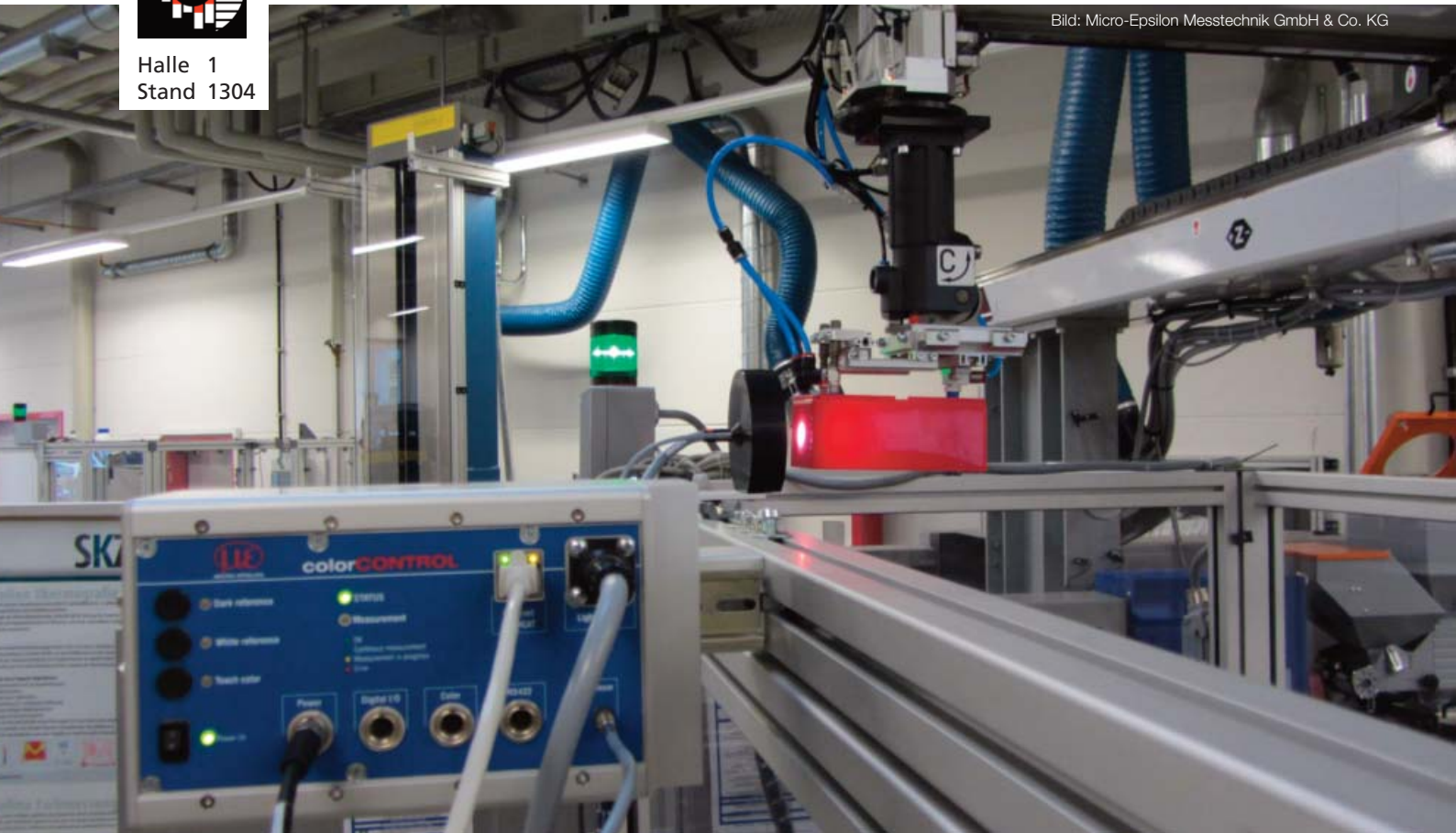
Bild 1 | Mit einem Inline-Farbmesssystem kann direkt nach der Entnahme eines Kunststoff-Spritzteils aus der Form eine 100%-Farbkontrolle durchgeführt werden. Dabei wird auf eine empirisch ermittelte Korrelation der Farbe zwischen warmen und kalten Teilen zurückgegriffen.
