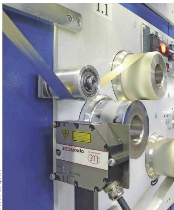
Der Laser-Sensor optoNCDT 2300 wird für die Inline-Qualitätssicherung in der Produktion von metallischem Band eingesetzt
