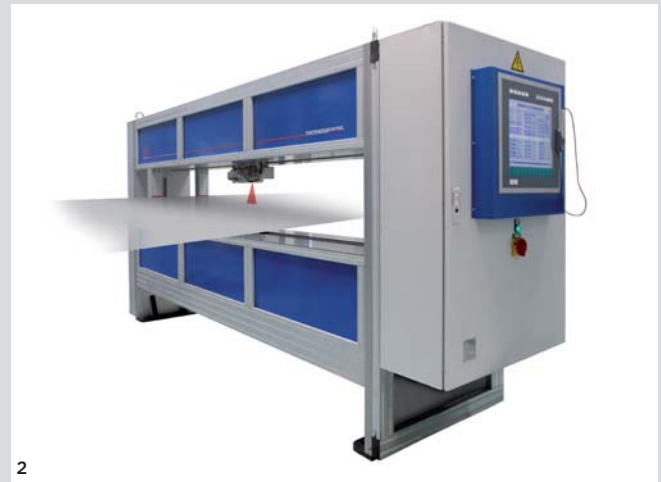
1 Laserlinienscanner auf einem C-Rahmensystem bei Amag Ranshofen. 2 Bei der Einbindung der Profilmessung in eine Spaltanlage können alle Streifen in Breite und Profil gemessen werden. 3 Komplettvermessung inklusive Längenprotokoll.
