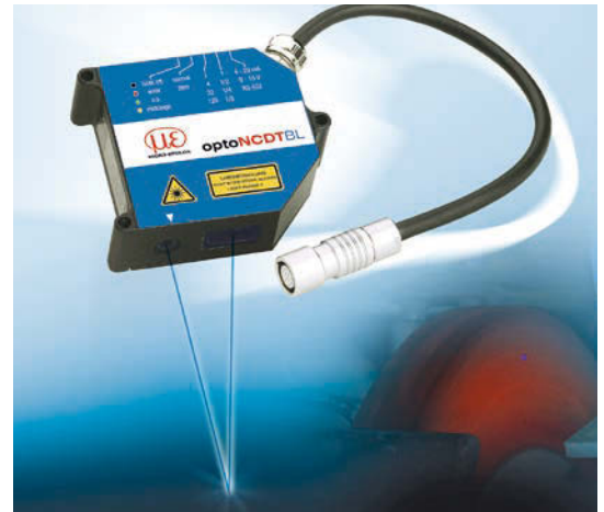
Laser-Triangulationssensoren mit der blauen Laserdiode vermessen sicher und präzise auch auf glühenden Metallen und glühendem Silizium.
