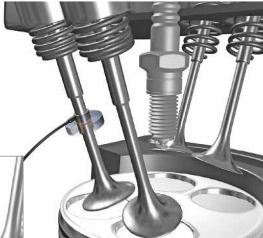
Ventilhubsensor zur variablen Ventilsteuerung in einem Verbrennungsmotor
