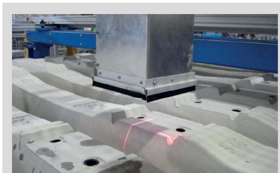
Laserprofilscanner ScanControl vermessen die Eisenbahnschwellen in einem Spannbetonwerk bei aggressivem Staub und hohen Temperaturschwankungen.
