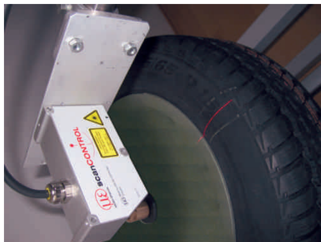
Laser-Linien-Scanner scanCONTROL werden für die Profil- und Konturmessung im laufenden Fertigungsprozess eingesetzt. Abb.: Micro-Epsilon
