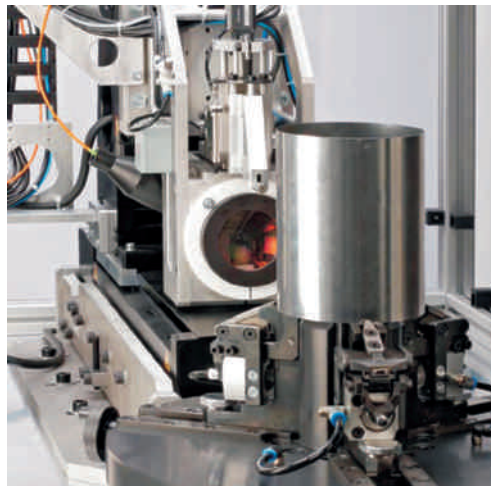
Exakte Durchmesserbestimmung von Edelstahlrohren. Das confocalDT-Messsystem ist mit EtherCAT vernetzt.
