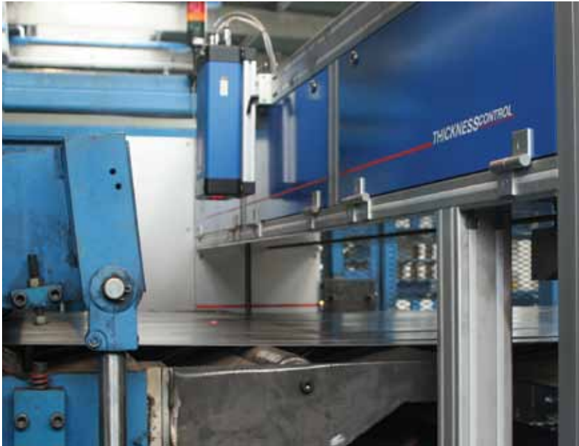
Die Anlage im Einsatz bei der Längsteilschere. Geprüft werden die Geometrien der einzelnen Bänder.
