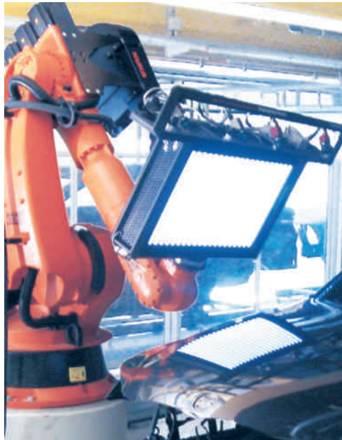
Bis zu vier reflectControl-Systeme, die in einer Messzelle an Robotern appliziert sind, kontrollieren die Karosserien.
