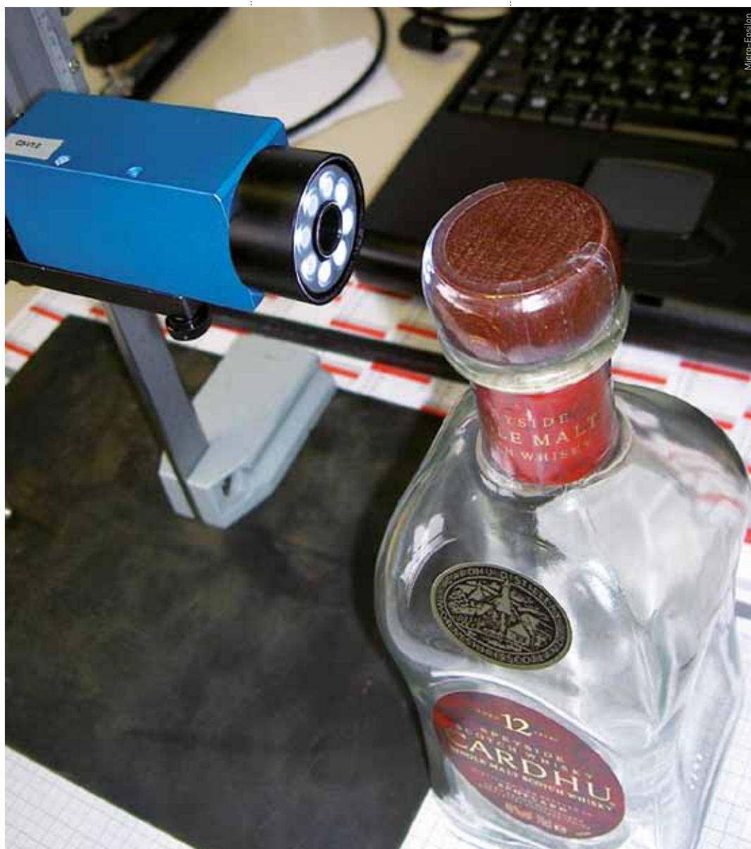
Per Farberkennung lässt sich prüfen, ob die Versiegelungsfolie auf dem Flaschenverschluss ist.
