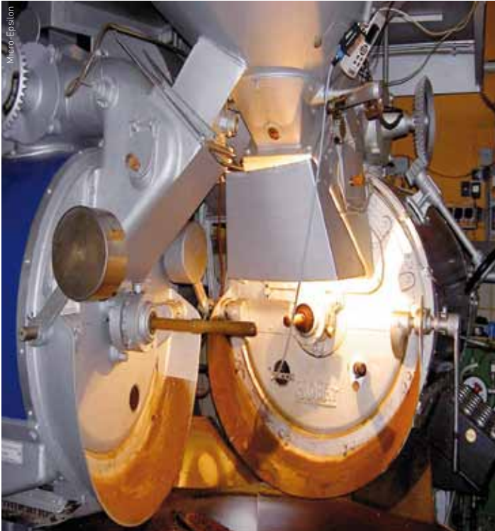
Der Bräunungsgrad der Bohnen kann per Farbsensor protokolliert werden.
