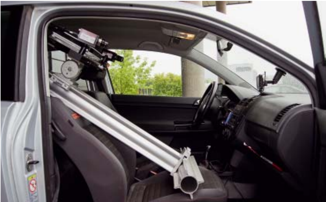
Surfacecontrol auf einer mobilen Halterung montiert überprüft die Oberfläche der Instrumententafel
