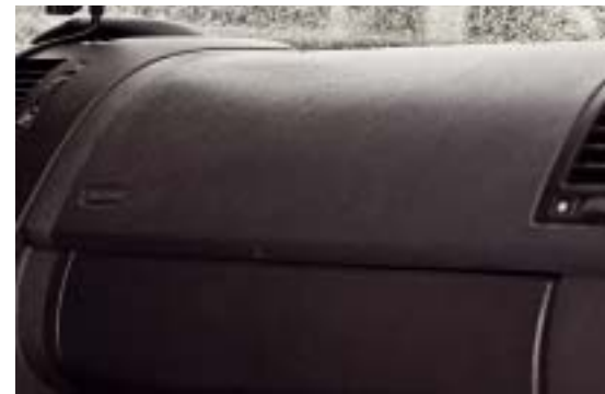
Dellen treten in der Instrumententafel an den Sollbruchstellen für Airbags auf. Sie verzerrten die Qualitätsanmutung des Fahrzeugs
