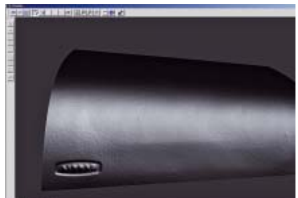
Nach der Messung lässt sich von dem gemessenen Objekt ein exaktes 3D-Bild erzeugen
