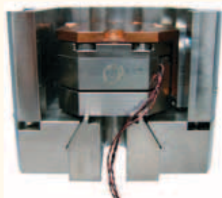
Bild 3: In Rasterkraftmikroskopen werden die Sensoren auf -269 °C gekühlt. Bei starken elektromagnetischen Feldern messen sie die Bewegung der Nanopositioniereinheit.
