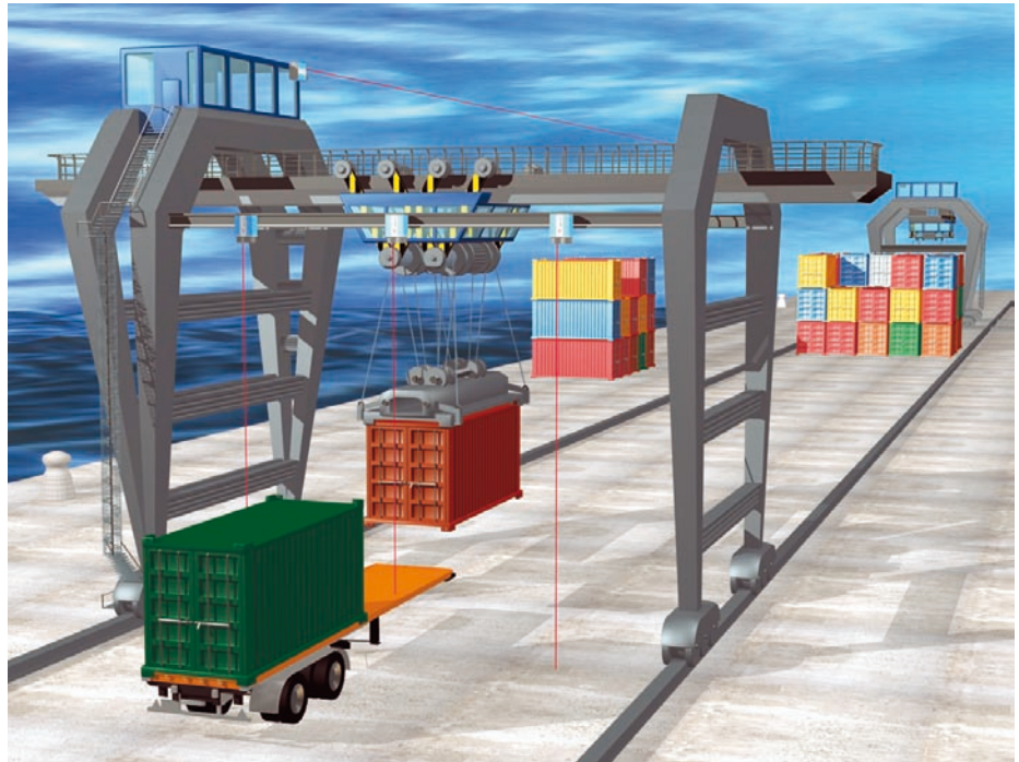
Das 3-D-Bild zeigt mögliche Anwendungen für Laser-Distanzsensoren am Portalkran
