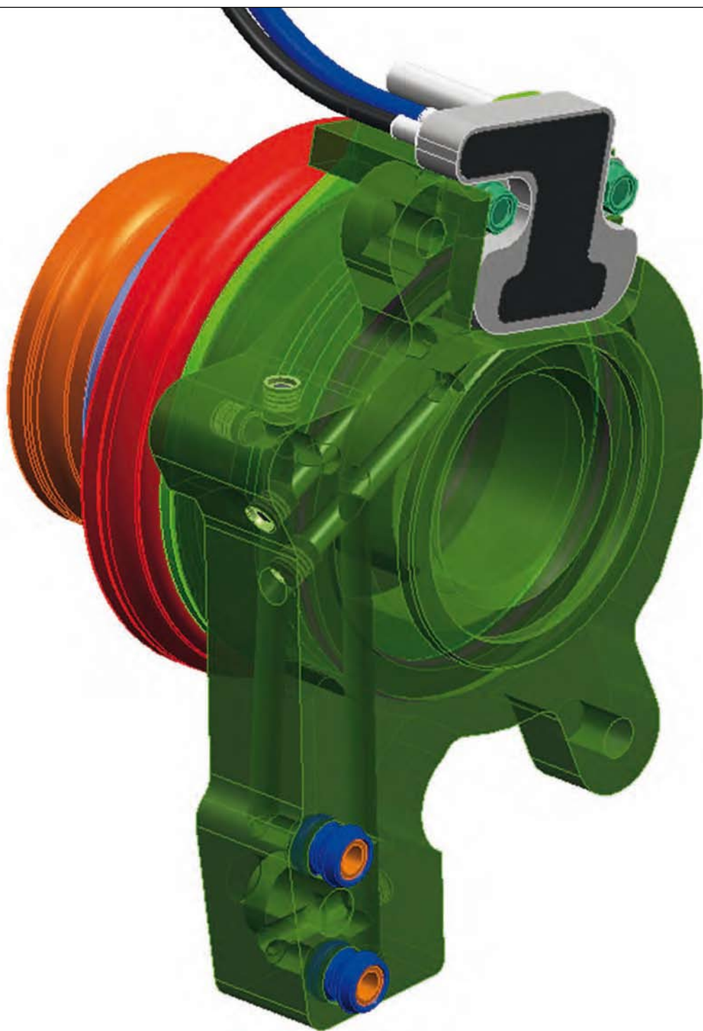
Das 3D-Modell zeigt deutlich die Position des Sensors am Einrucker einer Doppelkupplung.
