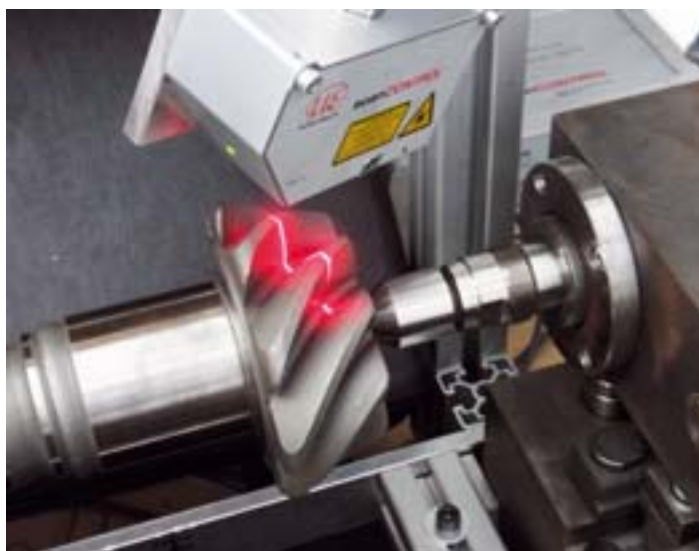
Per Laserstrahl werden die Zahnflanken eines rotierenden Kegelrads erfasst Bilder: Micro-Epsilon
