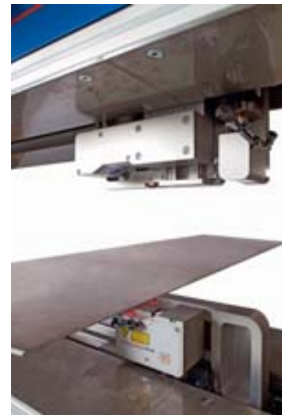
In der Anlage werden Laser-Scanner verwendet. Diese liefern insbesondere bei Metallen sehr präzise Daten
