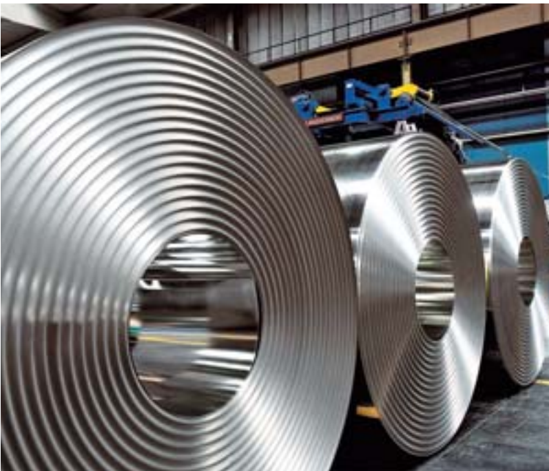
Coils sind der Rohstoff für viele Produkte. Wichtiges Qualitätskriterium ist dabei die Dicke
