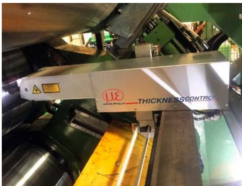
Um den Prozess in einem Vier-Walzen-Kalender komplett zu überwachen, werden zwei Systeme eingesetzt, die die Produktdicke aus dem oberen und unteren Walzenspalt überwachen. Bilder: Micro-Epsilon
