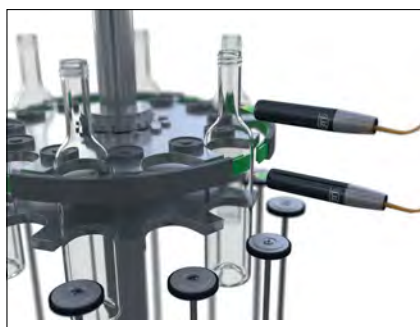
Bei der Produktion von Behälterglas stellen die Wandstärke und die Rundheit der Flaschen ein wichtiges Qualitätsmerkmal dar. Im laufenden Prozess müssen deshalb diese Größen zu 100 % kontrolliert werden.
