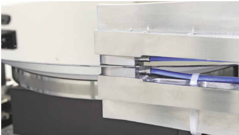
Zweiseitige Dickenmessung eines Wafers
