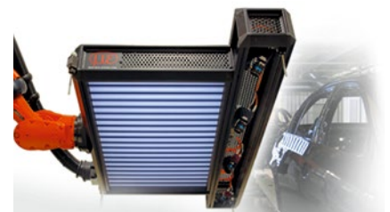
Die Lackfehlerkontrolle erfolgt mittels eines industrietauglichen Deflektometrie-Sensors
