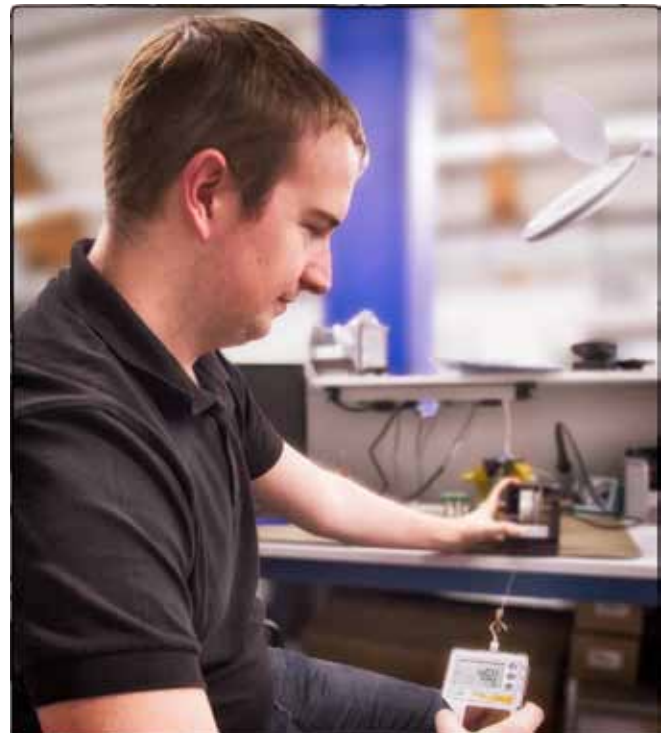
Mithilfe eines Kraftmessgeräts misst der Mechatronikingenieur die Rückzugskraft eines Seilzugsensors.
