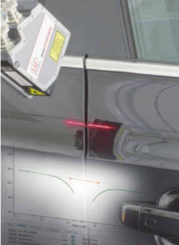
GapControl führt die Spalt-/Bündigkeitsmessung an Karosserieteilen durch
