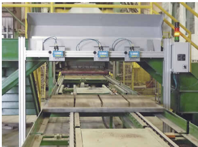
Bei der Vermessung von Betonsteinen kommen Laser-Triangulationssensoren zum Einsatz
