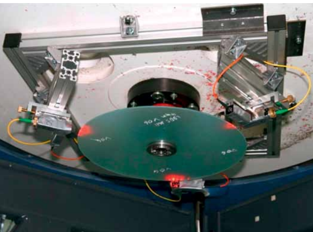
Bild 2. Drei fasergekoppelte Laser-Doppler-Distanz-Sensoren erfassen mikrometergenau die Form einer dynamisch beanspruchten GFK-Scheibe.
