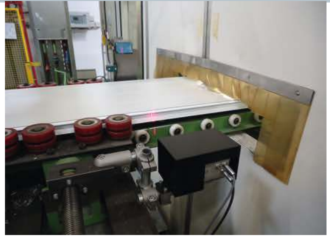
4 Der Laser-Linienscanner scanControl wird für die Profil- und Konturmessung im laufenden Fertigungsprozess eingesetzt. Links, scanControl bei der Überprüfung eines Reifens auf Beulen und Einschnürungen, rechts: bei der Prüfung von Sektionaltoren
