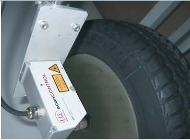
4 Der Laser-Linienscanner scanControl wird für die Profil- und Konturmessung im laufenden Fertigungsprozess eingesetzt. Links, scanControl bei der Überprüfung eines Reifens auf Beulen und Einschnürungen, rechts: bei der Prüfung von Sektionaltoren
