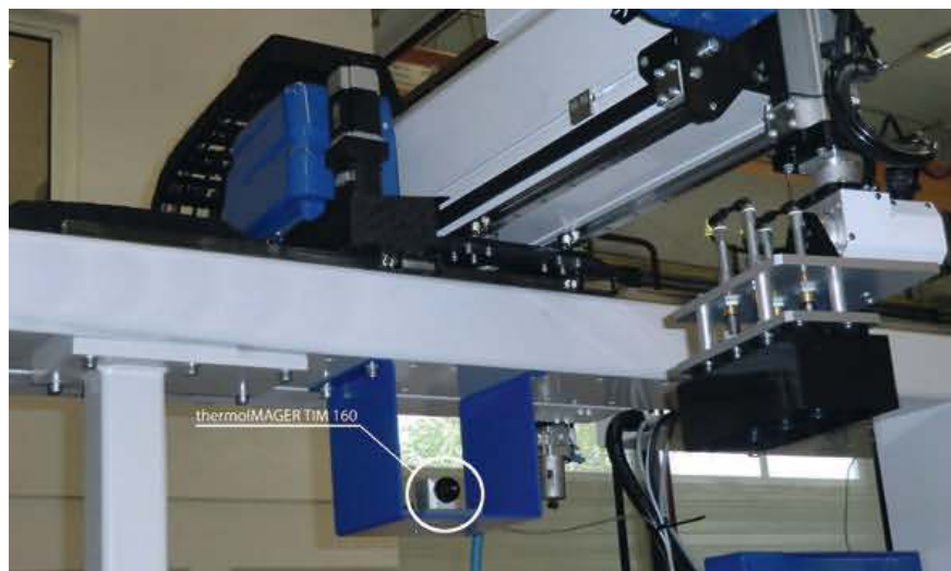
6 Die Wärmebildkamera »thermoMAGER TIM« bei der Inline-Qualitätsprüfung bei Spritzgussmaschinen: Die Kamera erkennt nicht nur die sichtbaren Defekte, sondern auch verdeckte Materialfehler
