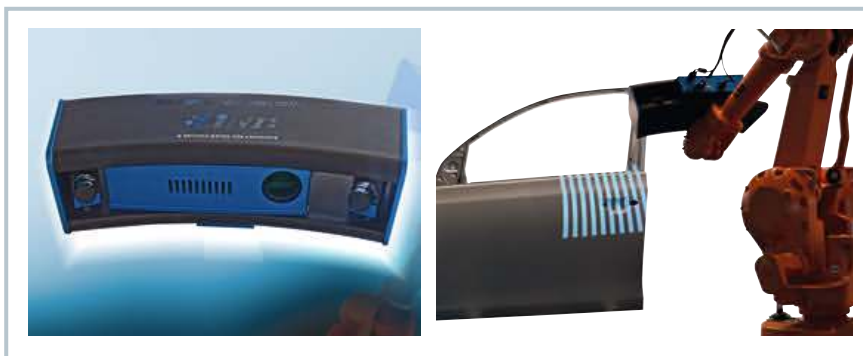
5 3D-Inspektionssysteme surfaceCobtrol (links) werden für diffus reflektierende Oberflächen eingesetzt und arbeiten nach dem Verfahren der Streifenlichtprojektion (rechts). Damit lassen sich lokale Formfehler (Beulen und Dellen), die nur wenige µm vom Sollmaß abweichen, in Oberflächen erkennen und analysieren
