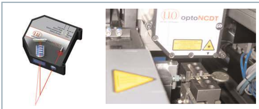
3 Punktlaser-Sensoren wie der »optoNCDT« (links) zählen zu den berührungslosen Standardmesssystemen. Rechts: zum Beispiel zur Qualitätsprüfung von Schlüsselrohlingen
