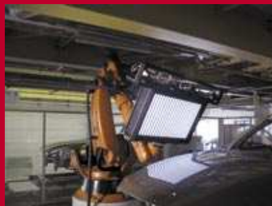
2007 Einführung von 3D-Defektmesssystemen zur Lackprüfung in der Automobilindustrie
