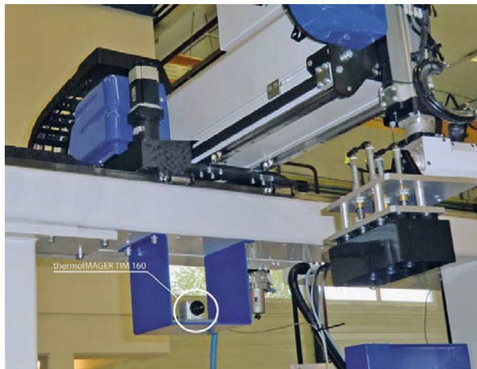
Das In-line-Thermografieprüfsystem in einer Spritzgießmaschine. Foto: Micro-Epsilon
