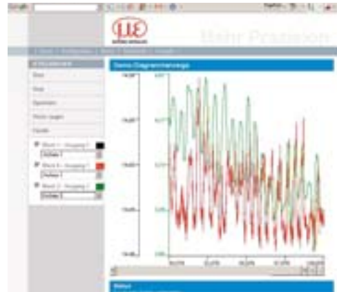
Als Bedienoberfläche für den Universal-Controller CSP2008 dient ein Standard-Webbrowser
