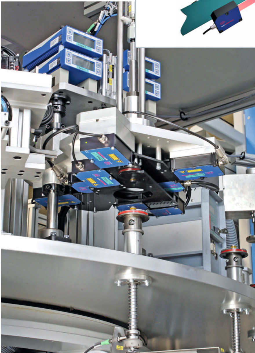
Bild 3. Durch das Baukastenprinzip lässt sich die Mechanik der Sensoren zur Spalt- und Kantenmessung an die Anwendung anpassen.
