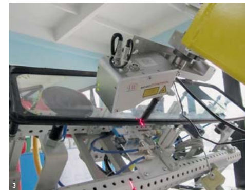
1 Der Sensor wird über viele Freiheitsgrade bewegt. Minimales Gewicht ist dabei wichtig. 2 Die Laserlinie wird nah an die Düse positioniert, um eine durchgängige Messung zu ermöglichen. 3 Alle Anschlüsse sind direkt im Gehäuse integriert.
