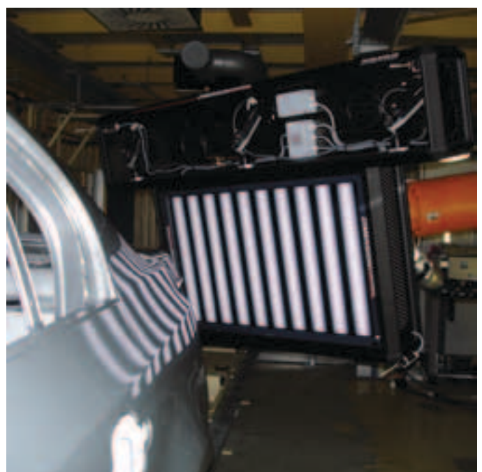
Bild 4: Inspektion eines Fahrzeughecks mittels Auswertung von Reflexionen
