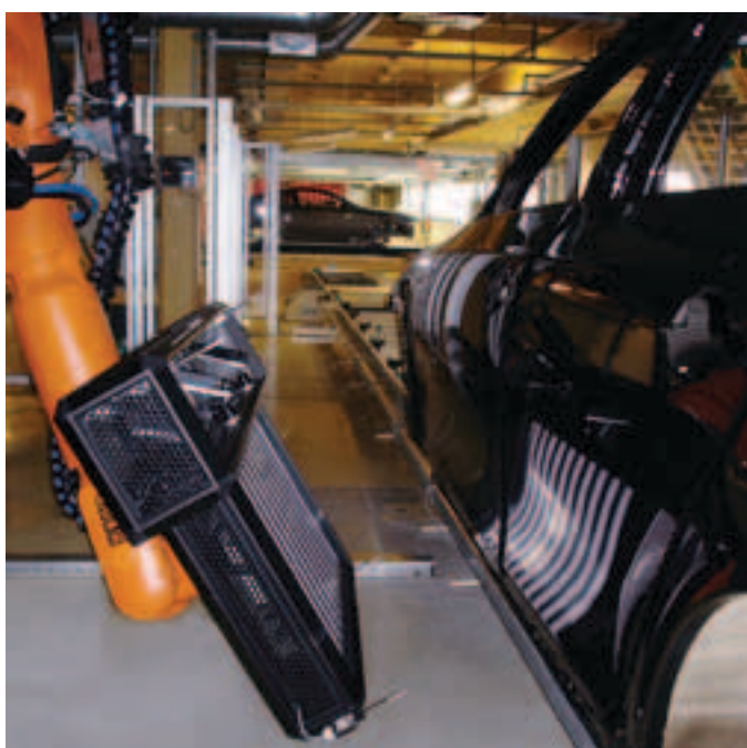
Bild 3: Qualitätskontrolle einer Autotür unter realistischen Testbedingungen
