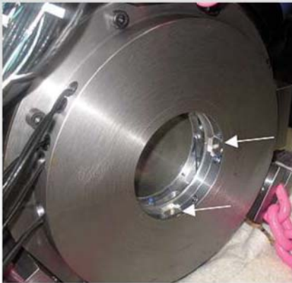
Die Sensoren sind in den Prüfstand integriert und messen dort den Schmierpalt des Gleitlagers.
