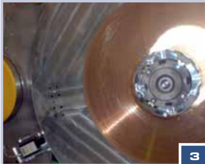
Bild 3. Der OptoNCDT ILR misst seitlich auf das Metallband; die besondere Anordnung erlaubt höchste Messgenauigkeit
