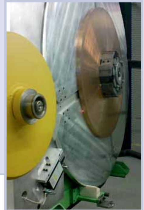
In einer Umspulanlage werden aus einzelnen Metallbandringen fertige Coils erzeugt
