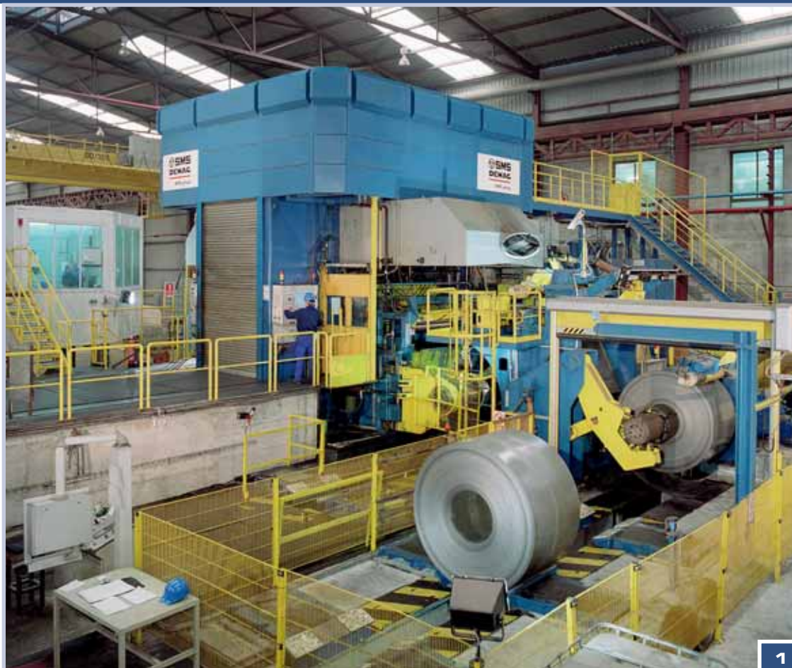
Bild 1. In der automatisierten Produktion veranlasst der Durchmesserwert des Coils den automatischen Wechsel
