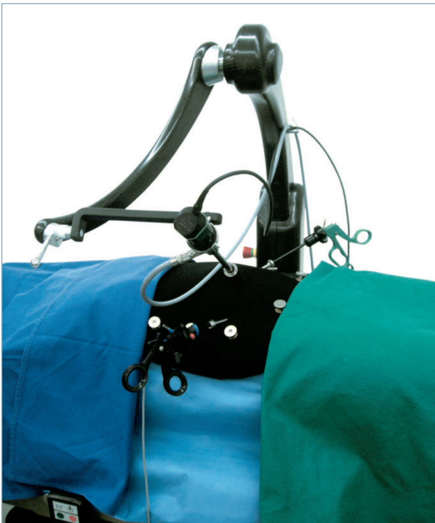
Bild 2. Mit einem OP-Gerät, das einen Arm nachbildet, kann der operierende Arzt auch die Steuerung des Endoskops übernehmen.
