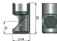
TM-RAM-CS Right angle mirror
