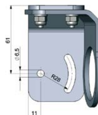
TM-AB-CTL Montagewinkel (verstellbar)
