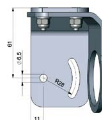
TM-AB-CTL Equerre de montage (ajustable)
