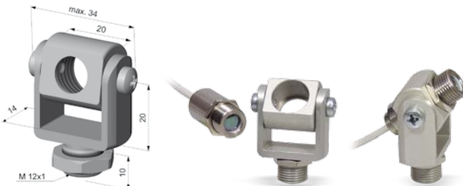
TM-MG-CT Montagegabel mit M12x1-Gewinde, justierbar in 2 Achsen
