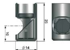
TM-RAM-CS Right angle mirror
