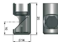
TM-RAM-CS Right angle mirror
