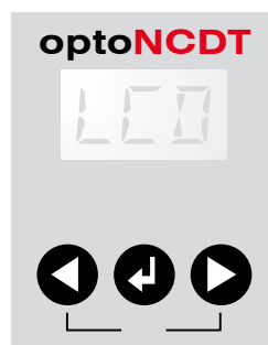
ILR1100/ILR1150: Entrée de la distance de déclenchement via le logiciel
