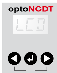
ILR1100/ILR1150: Einstellen der Schaltpunkte erfolgt direkt am Sensor oder über Software ILR-Tool
