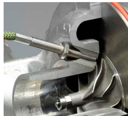
Grandes distances de mesure à l'aluminium et au titane
