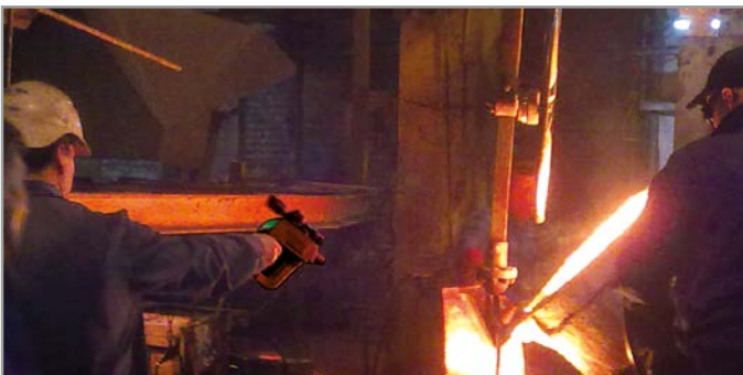
Berührungslose Temperaturmessung aus einer sicheren Entfernung
