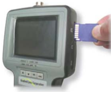
Abb. 4 Installation der SD-Speicherkarte
