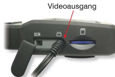
Abb. 8 Anschluss AV-Kabel am Video-Endoskop
