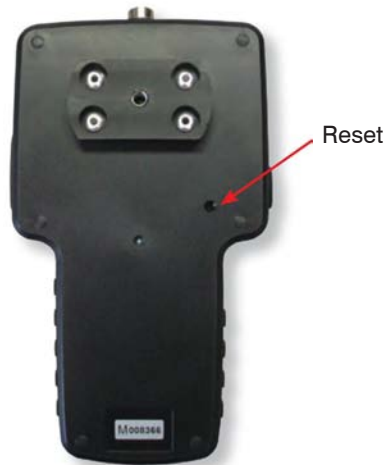
Abb. 11 Rückseite des Videomonitors mit Reset-Taste
