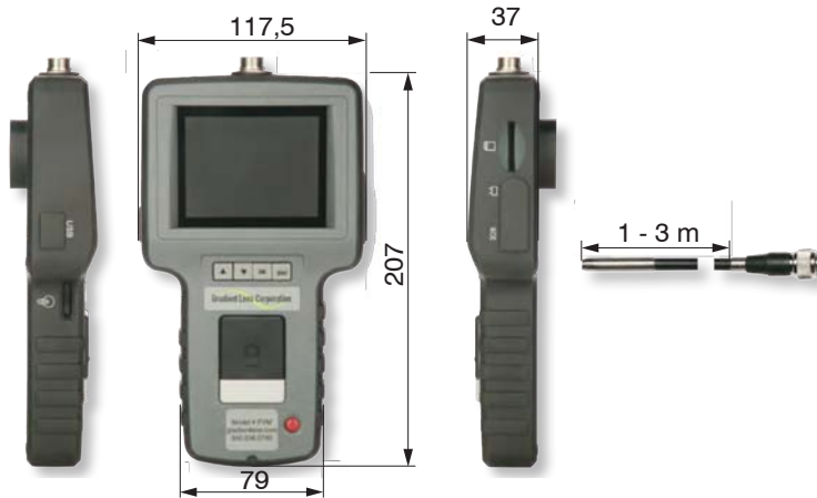
Abb. 3 Maßzeichnung Video-Endoskop, Abmessungen in mm, nicht maßstabsgetreu
