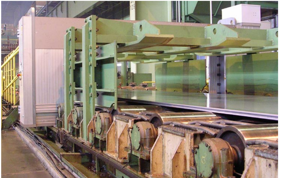
Dickenprofilbestimmung von Aluminium-Platinen (Foto: AluNorf)
