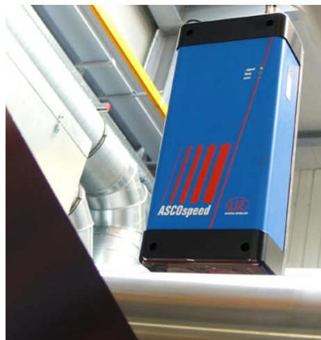
ASCOSpeed misst auf NE-Band (Foto: MICRO-EPSILON)
